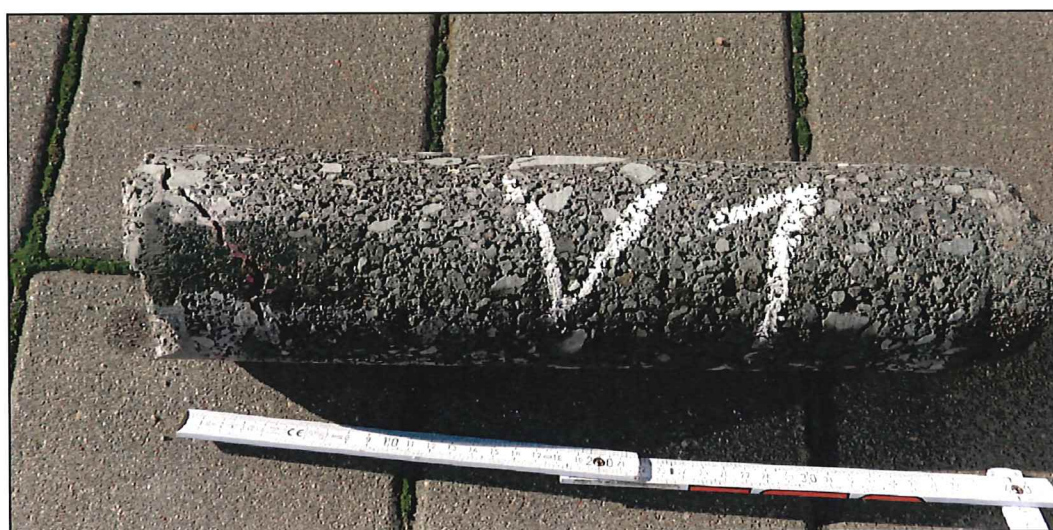
Obrázek 15 - výnos z vrtu VK1 – druhá část 35 - 65 cm, první část vrtu z hloubky 0 - 35 cm se rozpadla při vyjímání z vrtu
