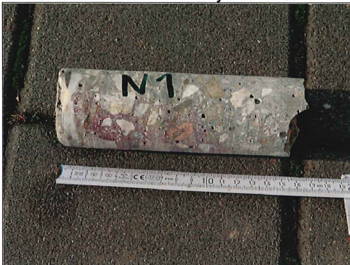
výnos z vrtu s fenolftaleinovým testem
