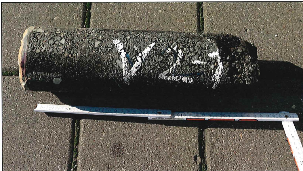
Obrázek 16 – výnos z vrtu VK2, první část 0 - 35 cm
