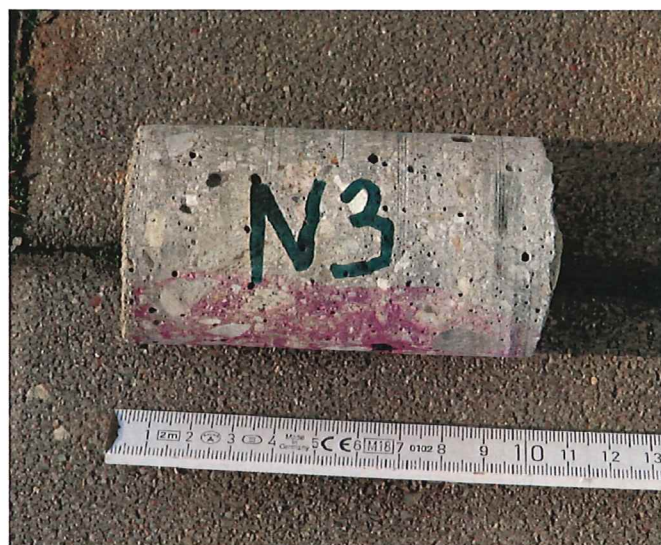
výnos z vrtu s fenolftaleinovým testem
