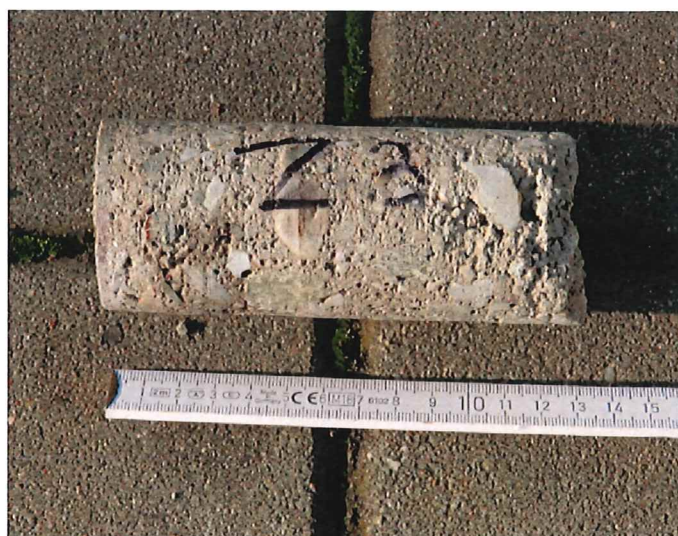
výnos z vrtu s fenolftaleinovým testem
