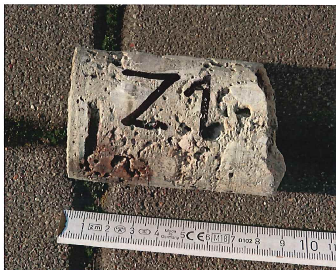
výnos z vrtu s fenolftaleinovým testem
