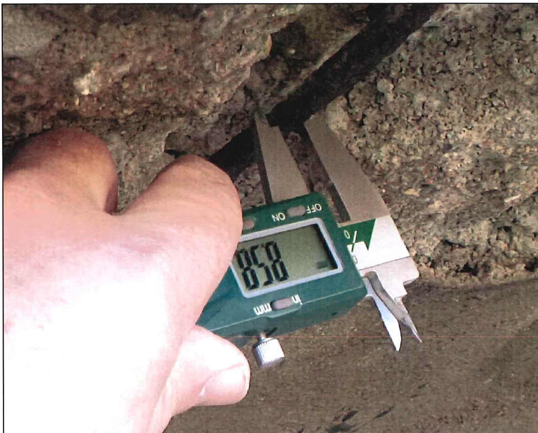
Obrázek 28 – skutečný průměr výztuže 8,6 mm, použitá výztuž má mít podle původní projektové dokumentace \varnothing 10 mm, korozní úbytek tak činí 14 %
