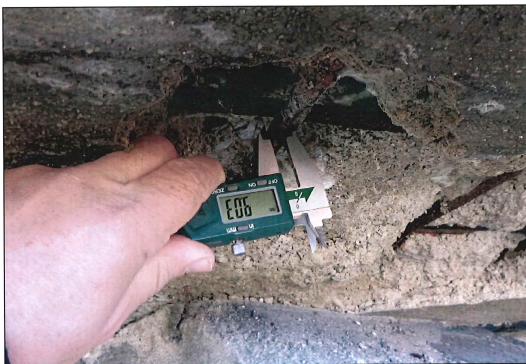
Obrázek 27 – skutečný průměr výztuže 9 mm, použitá výztuž má mít podle původní projektové dokumentace \varnothing 10 mm, korozní úbytek činí 10 %
