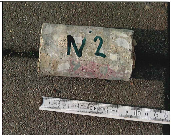
výnos z vrtu s fenolftaleinovým testem
