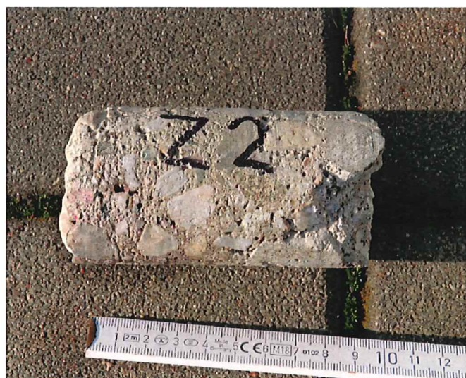
výnos z vrtu s fenolftaleinovým testem
